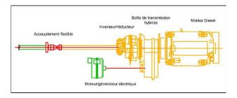
Le moteur diesel et un moteur électrique se partagent le même arbre d'hélice
